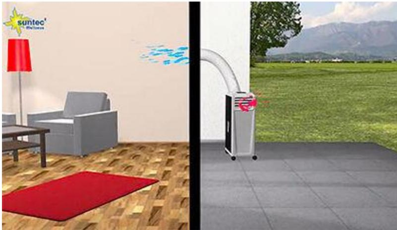
Il faut positionner le tube d'extraction d'air chaud à la place de la grille de sortie d'air frais, puis le raccorder à la pièce à refroidir.
